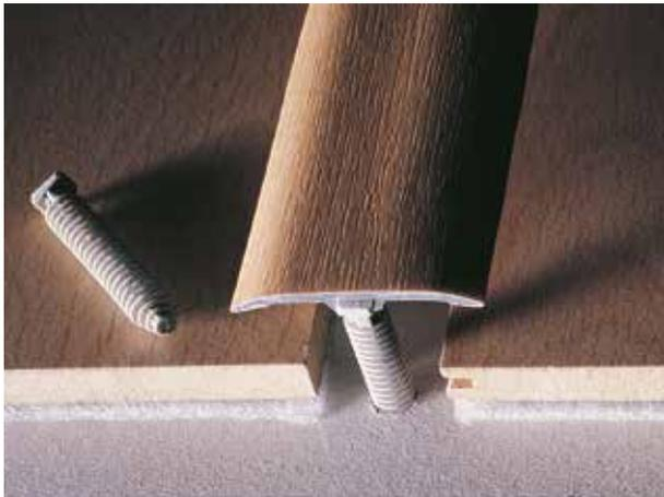
Anschlußprofil für Beläge gleicher Höhe, welches auch den Ausgleich kleinere Höhenunterschiede ermöglicht. Das Profil wurde besonders für den Privatbereich konzipiert, dadurch erfolgt die Fixierung mit den Nylondübeln MULTIFIX.
